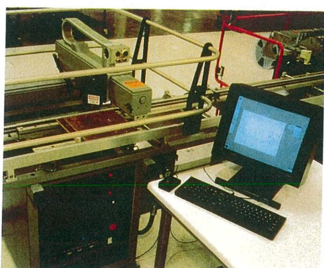
写真3 NeXT マシンによって最適化されたプログラムがロボットにダウンロードされる。
