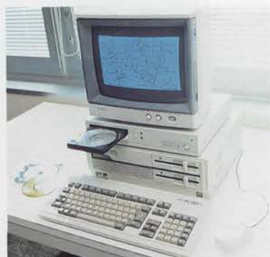
CD-ROM CD-ROMとパーソナルコンピュータを使用して電子化されたカタログ(イメージデータとテキストデータ)を表示、検索することができます。このシステムによって検索時間を短縮し、見積、発注のミスを大幅に減少できます。
