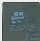
アスキーのLSIはソフトウェアのノウハウが凝縮された「シリコンソフトウェア」です。上段 V3400A、M6285Y (VGA CHIP SET)、下段 左から M6285Y (VGAチップセット)、DATコントローラ、IIT3057 (高性能画像処理チップセット)。
