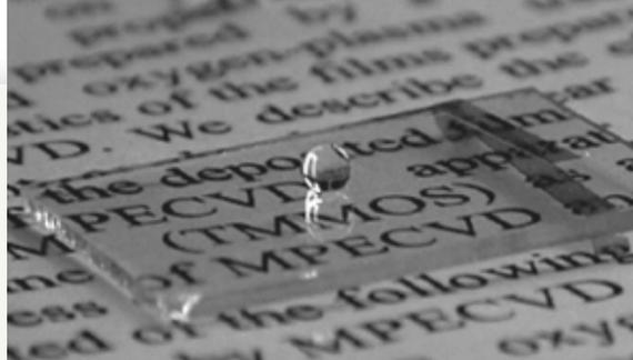
プラズマを用いたガラスへの透明な超はっ水コーティング
