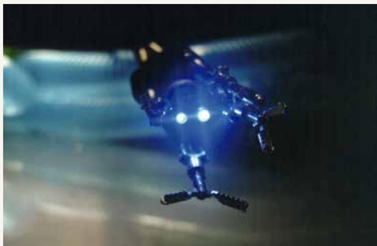
内視鏡型手術ロボットの先端にあるロボット鉗子
